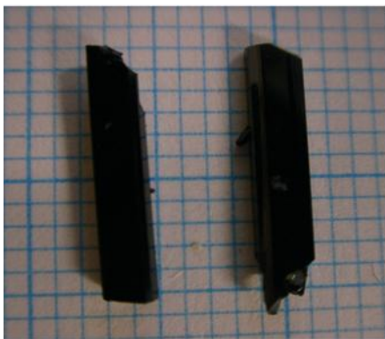
図 (左) 当研究室で合成した 50 mg 級 \beta' -(BEDT-TTF) _2 ICl _2 の大型単結晶。(中) 特異な磁気構造が明らかになった \kappa -(BEDT-TTF) _2 Cu[N(CN) _2 ]Cl の結晶構造。(右) \beta' -(BEDT-TTF) _2 ICl _2 の常磁性と反強磁性状態における \mu SR 実験結果。
